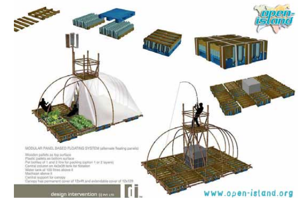
Konstruktionsweise des Open-Island Bausystems
